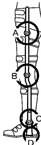
図-39 遊動継手の加算方法
