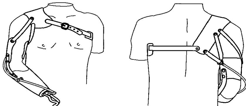
図-15 8字ハーネス式と上腕カフの組み合わせ例
