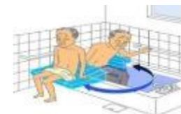
・ロボット技術を用いて浴槽に出入りする際の連続の動作を支援する機器
