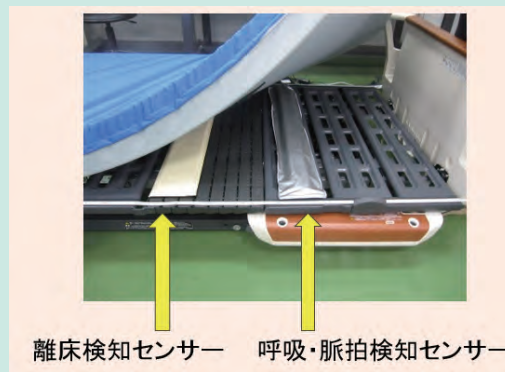
離床・見守りセンサー（ナースコール連動タイプ）のシステム概要
