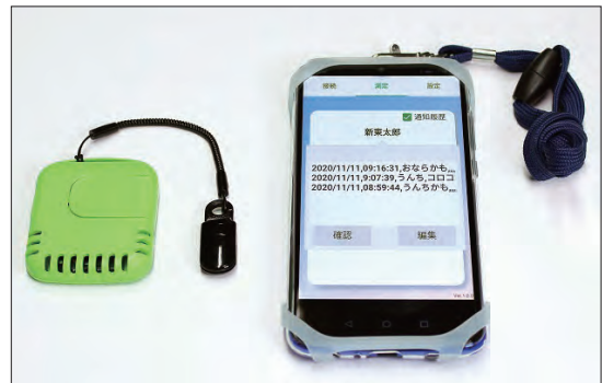
図1 排泄検知システム(左:排泄センサ、右:表示端末)
