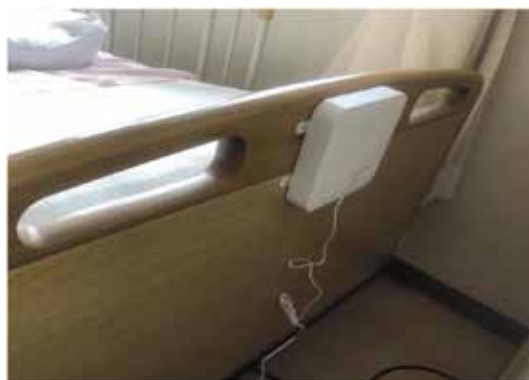
バイタルセンサーの設置状況
