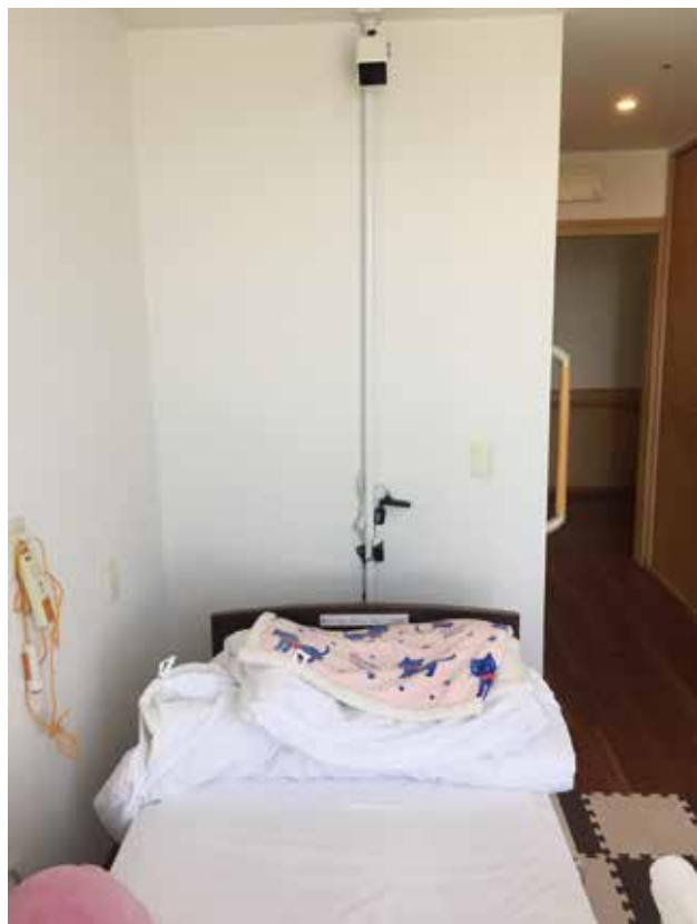
みまもり CUBE 設置図（ポール設置）
