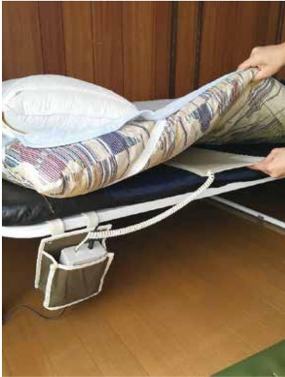
体動検知マットセンサ装置設置状況
