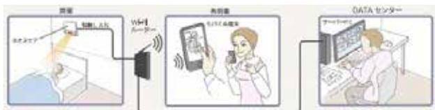
赤外線を用いたセンサーユニットは暗所でも昼間と変わらず24時間いつでも使用できます。センサーは、上下左右に角度調整可能でベッド周辺であれば自由に取付可能です。
