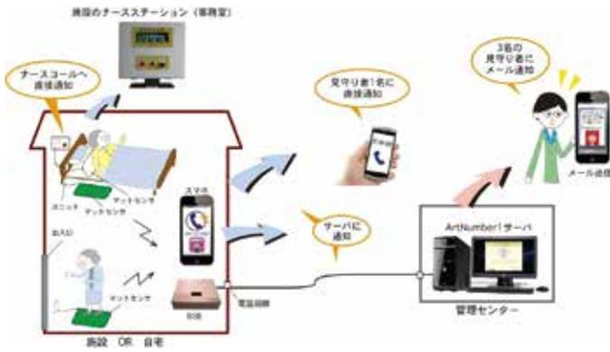
体動検知マットセンサ装置システム図
