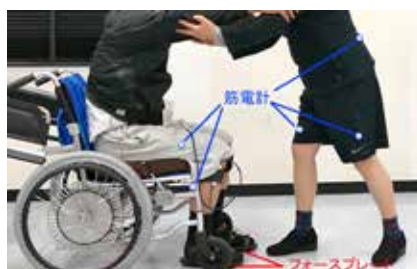
筋電計による筋力負担軽減の測定
