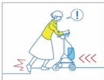
急な動きが発生し、バランスが崩れそうになった際にセンサーで感知!ブレーキ制御で転倒を防止。
