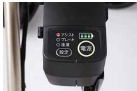
操作パネル。アシスト、ブレーキ、速度（制限）の設定が可能
