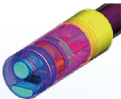
先端にCMOSイメージセンサと照明用LEDを配置
