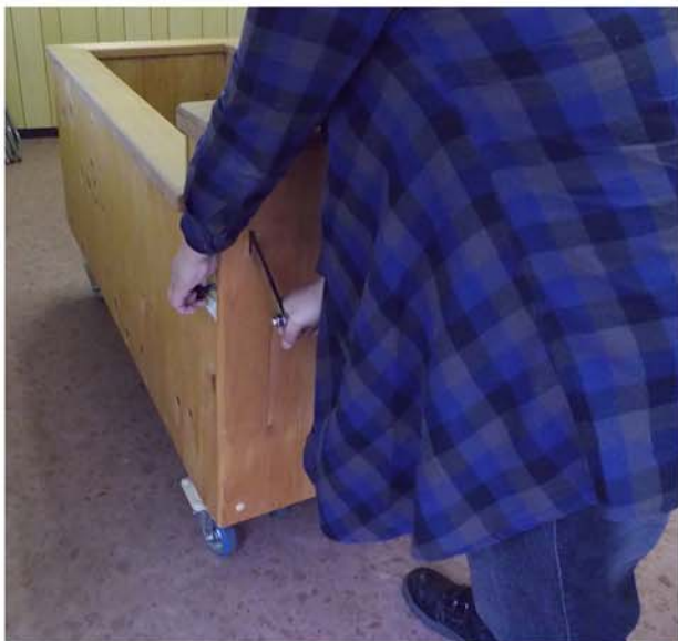
13. 排水が終わったら、レバーを下げながら ロックピンを引き、扉を解除します。
