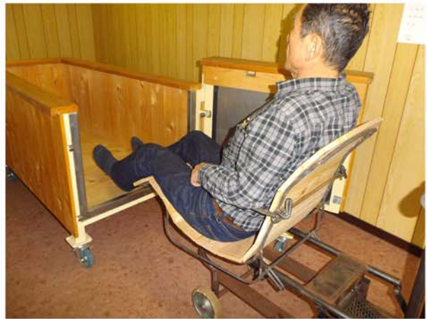
2, そのまま補助車を動かして、浴槽内に入ります。
