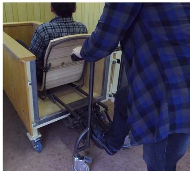
16. ステップを踏み座面を持ち上げます。
