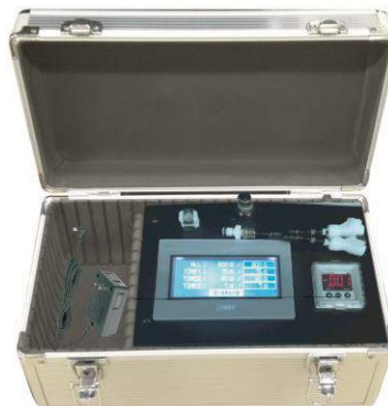
図2. コントローラ（タイマー及び圧力調整機能）
