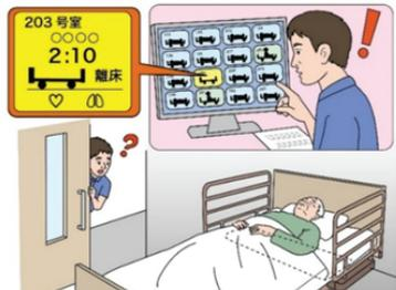
心拍や呼吸を読み取るセンサーでは、それらが読み取れない状態を離床と判断し表示するケースがあります。入床しているにもかかわらず離床と表示されている場合は心拍や呼吸が停止している状態を示し、亡くなっていることも考えられ、入室してベッドサイドで状態を確認すべきです。見守りセンサーの利用では、機器の特性を理解し状態に応じて訪室での確認を必須にするなどマニュアル化しておくことも重要です。
