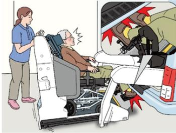
膝が曲がりにくい本人の身体状況、車いすの形状、リフトの大きさや昇降時の固定装置の有無などさまざまな条件が関係しますが、結果として重大な事故につながりかねない事象です。リクライニング車いすは全長が長くなるのでリフトを利用する時には可能な限りフットサポートは降ろし、操作中は常に目視確認するなど注意が必要です。リフトに車いすの固定装置がある場合には固定してから昇降操作を行うと危険の回避にもつながります。
