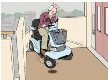
歩行の困難さや充電のため、集合住宅にある自宅の玄関先までハンドル型電動車いすで移動する必要があったのだと考えられます。階段付近などで切り返しを行なう際、ハンドルに取り付けられたバックミラーでは後進方向や床面の状況が映らず確認できません。狭いスペースで方向転換をする場合、とりまわしの練習などで安全を確認した上で納品し、日々の利用では介助者に後方を確認してもらうなど、十分に注意しましょう。
