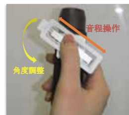
タッチスイッチ方式 使用方法
