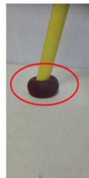
荷重時変形し接地
