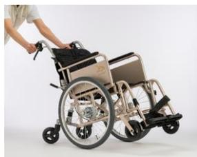
前輪キャスターを固定した6輪機構となっており、前輪を固定したことで軽微な力で直進走行ができると共に、踏切横断の際にも溝にはまらず走行することが可能。また、ハンドルにわずかに荷重をかけることで、後輪での方向転換が実現。
