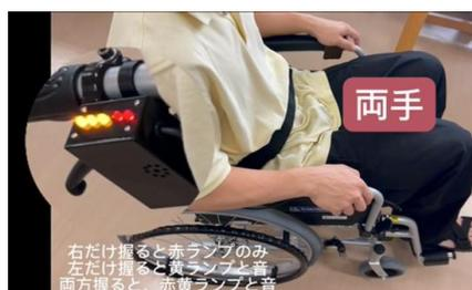
初心者が車いす移送介助の際に注意する点を学習できる車いすに取り外し可能な機器と学習方法のプログラムである。車いすを押してもらつ乗車者が、急なスピード変化・坂や段差・曲がり角などで「怖い」と感じた時に機器付属スイッチを握りしめることで、声など出さずともその気持ちを後方の車いす介助者に音や光で伝えることができる機器を用いている。
