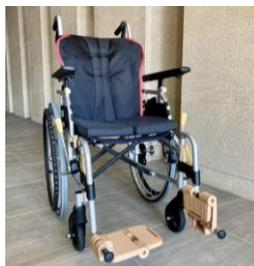
車椅子のフットサポートのプレート部分を左右で分割し、スプリングとPEライン（超高分子量ポリエチレン）を用いることで、フットサポートの開閉操作を容易にしました。これにより、開閉操作に介助を必要としていた方が自立できる可能性があります。また、介助者はプレートに触れることなく、非接触で操作可能となります。
