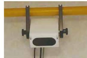
図2：トイレ用センサ。天井近くに設置
