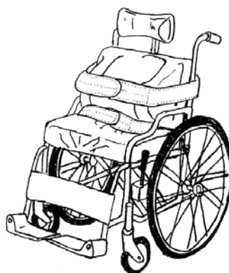
モールド型（車椅子の構造フレーム）
