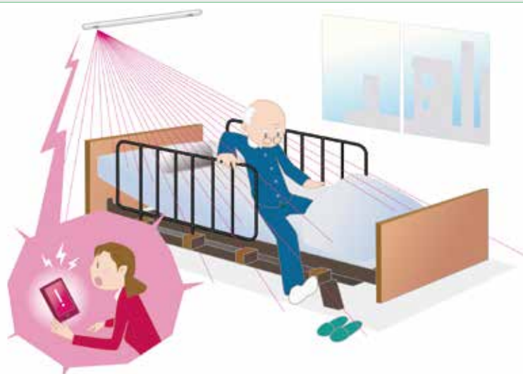
FG 視覚センサをもちいた認知症患者用 非接触ベット見守りシステム（アイデアクエスト）
