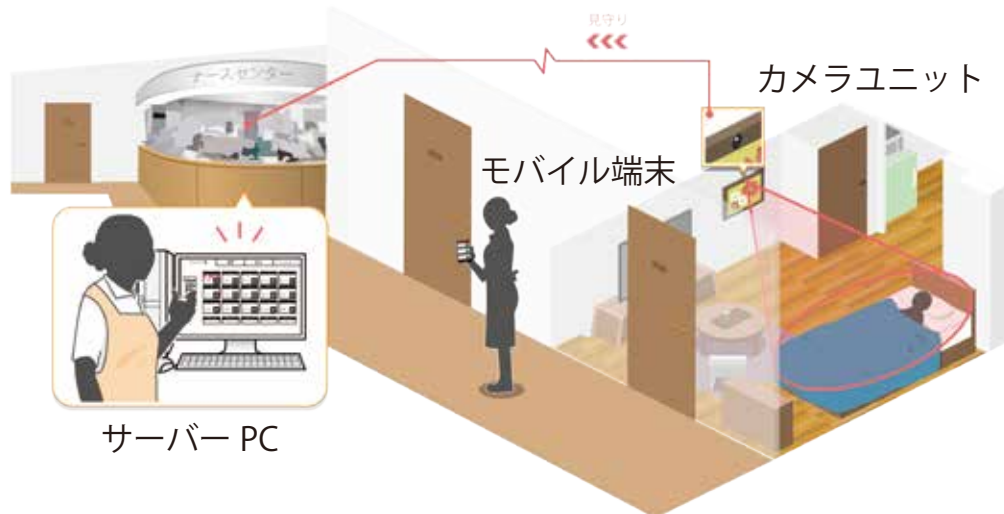
3次元電子マット式見守りシステム（ノーリツプレジジョン）
