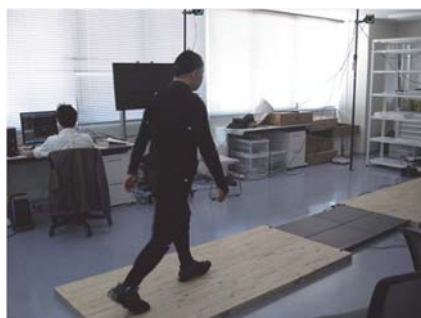
▲モーションキャプチャによる歩行測定実験
