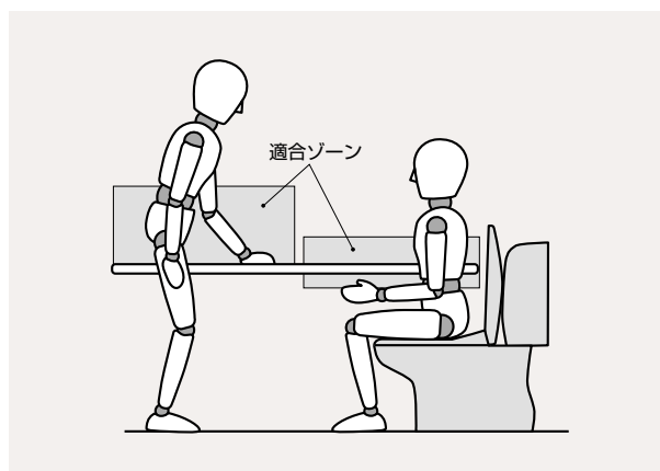
図8 一本の横手すりですべてのトイレ動作をカバーする
