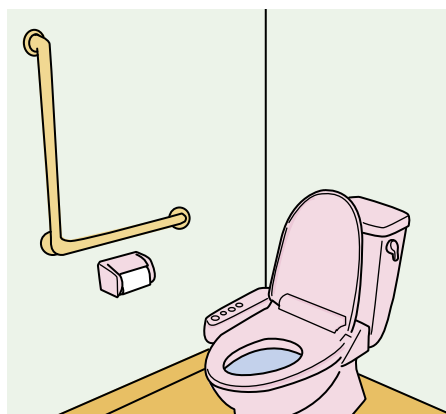
図6 住宅改修の手すり例
