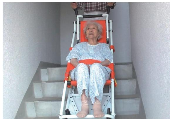
「カイダンサット」試作機による階段昇降
