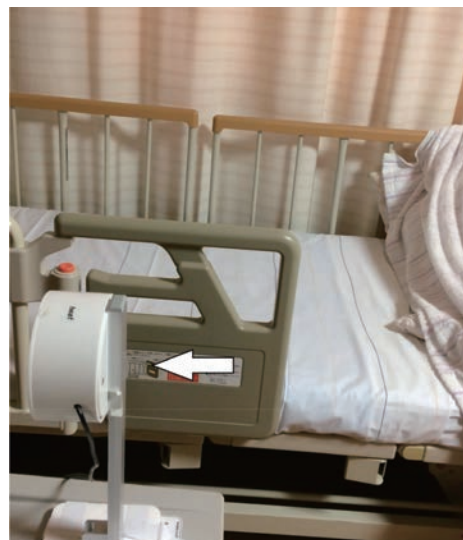
ベッドの手すり上部を検知範囲に設置
