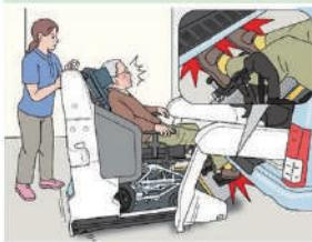
膝が曲がりにくい本人の身体状況、車いすの形状、リフトの大きさや昇降時の固定装置の有無などさまざまな条件が関係しますが、結果として重大な事故につながりかねない事象です。リクライニング車いすは全長が長くなるのでリフトを利用する時には可能な限りリフトサポートは降ろし、操作中は常に目視確認するなど注意が必要です。リフトに車いすの固定装置がある場合には固定してから昇降操作を行うと危険の回避にもつながります。
