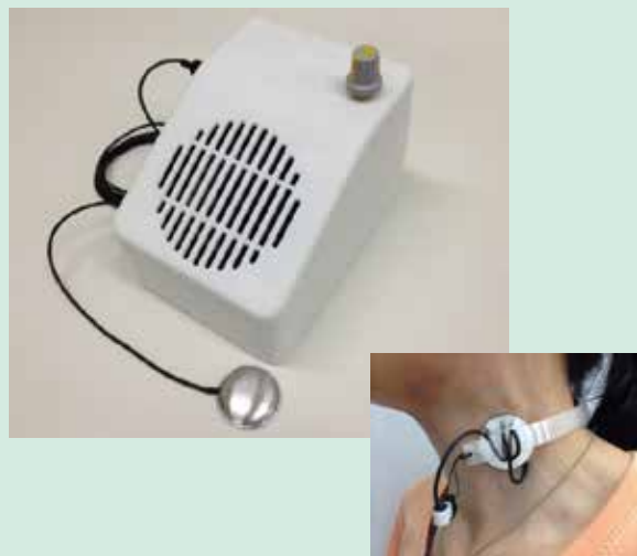
ごっくんチェッカー (センサー、スピーカーとネックホルダー)
