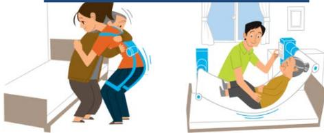
・ロボット技術を用いて介助者のパワーアシストを行う装着型の機器
