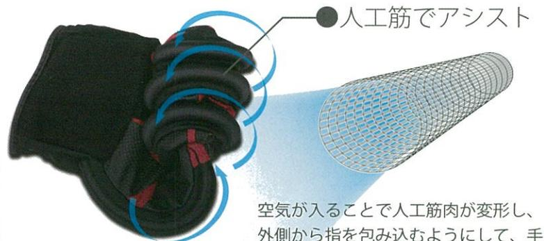
空気が入ることで人工筋肉が変形し、外側から指を包み込むようにして、手を握る動作を行います。
