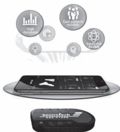
図 1 セノゲイトの使用イメージ センサーを装着した専用インソールを履いて歩行することで、スマートフォンのアプリでデータを取得可能だ
