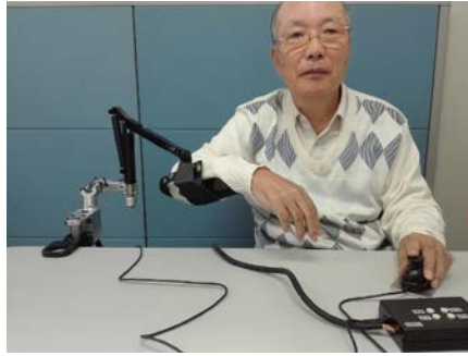
腕をスイッチ操作で上下に動かす
