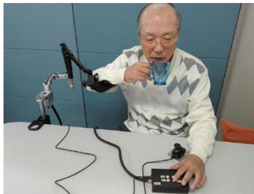
腕を任意の位置に固定できるためコップの水を容易に飲める
