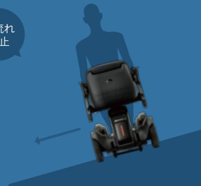
左右のモーターを適切に制御することで、横に傾斜した道でもまっすぐ走ることができます。
