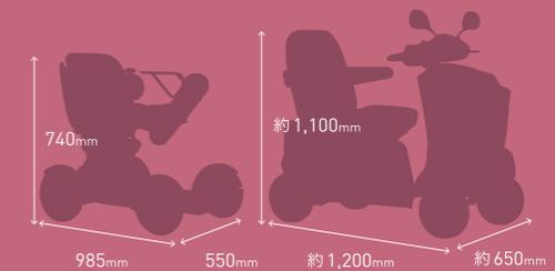
幅550mm×長さ985mm×高さ740mmのコンパクトさが、歩道での走行や室内での走行を快適なものにします。
