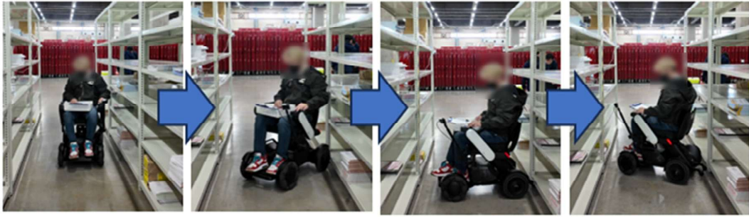
図 11 通路幅 900 mm における旋回(通路内)の様子 (B2)
