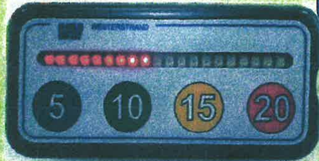
タイムログ20-1 20分までの4つのスイッチがあり、1分間に1つのLEDが点灯します。
